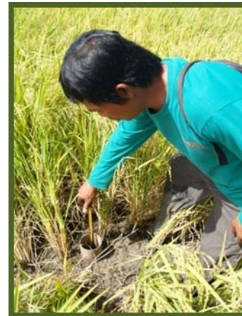
Paliwen iti kinangato wenno kina-uneg ti danum babaen ti panagaramat iti tubong a pag-obsarbaran (observation well)
